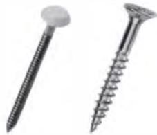
Die weißen Verkleidungsprofile werden im Abstand von 50 cm mit nicht rostenden Schrauben oder Nägeln befestigt. Beachten Sie bitte vor dem Zuschneiden und der Montage, dass sich die Kunststoffprofile in der Länge um ca.  $0,08 \text{ mm/m}^\circ\text{C}$  ausdehnen. Bei Wand- und Giebelverkleidungen, die ständig der Sonneneinstrahlung ausgesetzt sind, ist es dringend notwendig, die beschichteten Profile
